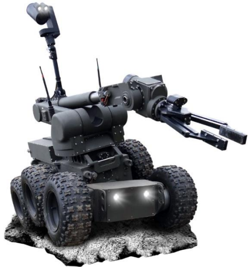
Fig. 2. IBIS robot presented by PIAP ( https://www.antyterroryzm.com/robot-ibis-dla-kolejnych-placowek-stazy-granicznej-w-polsce/ 2024.04)
